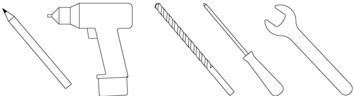
Stift, Bohrer  $\varnothing 8$ , Bohrer  $\varnothing 35$ , Schraubendreher, Gabelschlüssel (im Lieferumfang enthalten)
