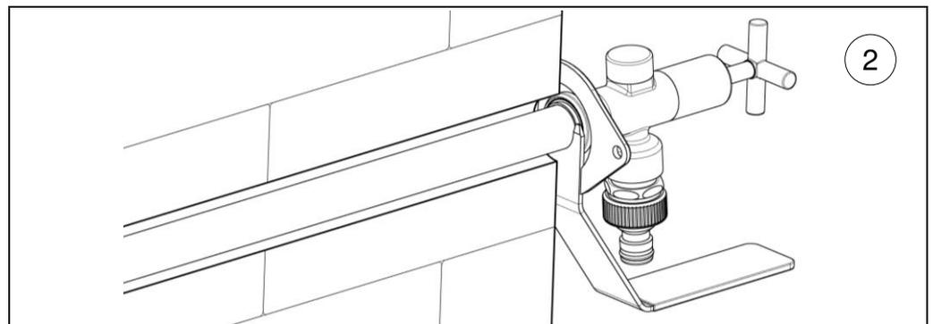
Demontagehebel nach unten drücken und damit Steckverbinder lösen.
