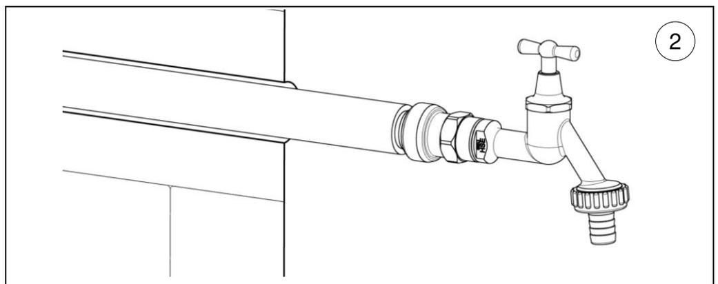
Das Auslaufventil kann mit der Schablone 1 von dem Rohrstutzen abgenommen werden
