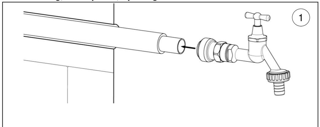
Armatur entlüften und sorgfältig spülen. Das Auslaufventil kann für die Druckprobe und für Zapfen von Bauwasser verwendet werden.
