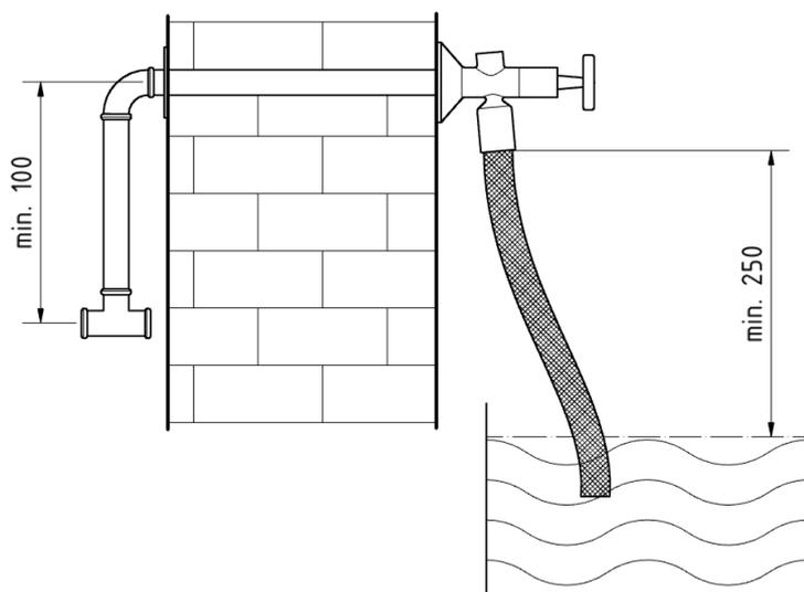
Für die Montage sind die jeweiligen Richtlinien für Trinkwasserinstallationen zu beachten. Die Montage darf ausschließlich durch sachkundige, qualifizierte Fachkräfte erfolgen. Bei fehlerhafter Montage kann es zu Wasserschäden kommen.
