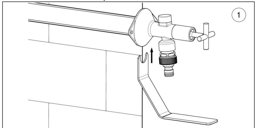
Der Demontagehebel muss bis zum Rohrstutzen eingeführt werden, um dort den Steckverbinder lösen zu können
