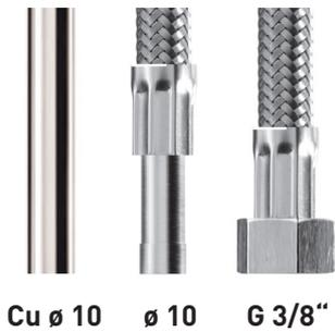
Durch die mehrteilige Konus-Quetschverschraubung **1** mit Längenausgleich können Kupferrohre und flexible Anschlusschläuche schnell und sicher montiert werden. Die Überwurfmutter mit durchgehendem Sechskant erleichtert die Montage. Bei Armaturen mit Anschlusschläuchen und Überwurfmutter wird diese direkt auf dem Ausgangsgewinde des Eck-/Eckregulierventils montiert.
